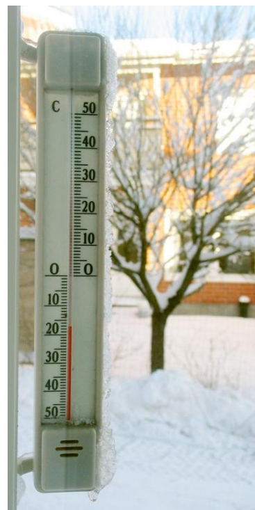
Un termometru tipic în grade Celsius care măsoară o temperatură a zilei de iarnă de -17^{\circ}\text{C}
